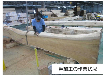
手加工の作業状況
